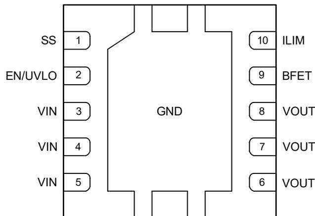
**Figure 1. DFN3x3-10L
