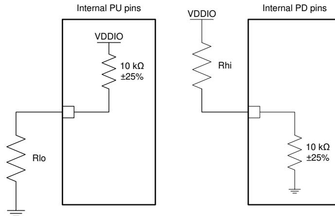
**Figure 7-6. Strap Circuit**
