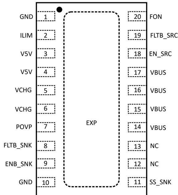
Figure 1. DFN3x5.2-20L
